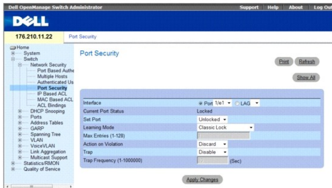
Рис. 7-7. Страница Port Security (Безопасность портов)
