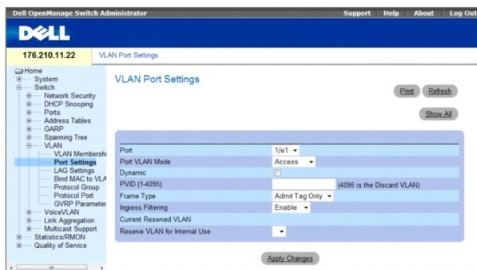
Рис. 7-48. Страница VLAN Port Settings (Параметры порта VLAN)
