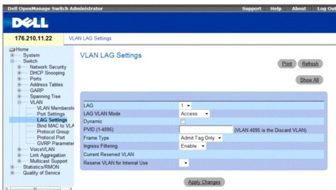
Рис. 7-50. Страница VLAN LAG Setting (Параметры группы LAG сети VLAN)
