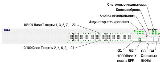
Рис 2-1. Передняя панель устройства PowerConnect 3524
