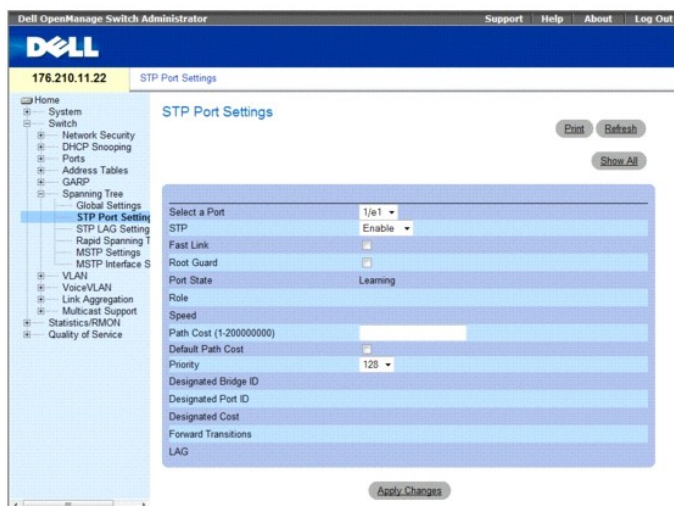
Рис. 7-36. Страница STP Port Settings (Параметры STP для порта)
